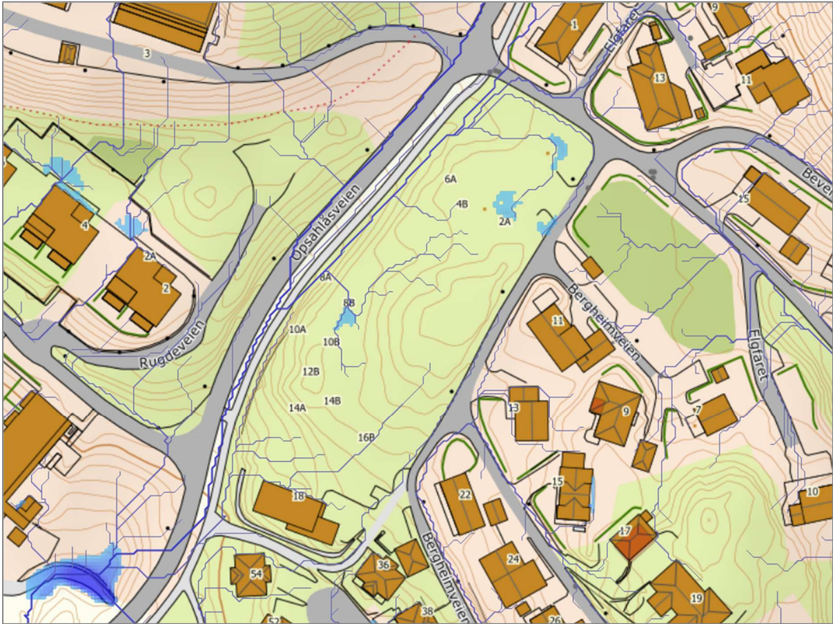
Figur 1 Avrenning fra tiliggende eiendommer samles ved inngangen til gang- og sykkelveien som går under Opsahlåveien.
